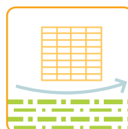
Använd underslag och se till att marken är dränerad
