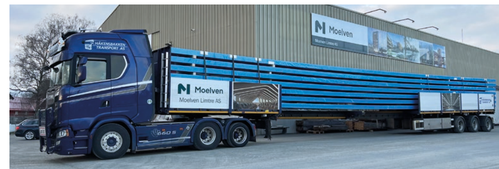
Komponenter av limträ är ofta så stora att de kräver specialtransporter. På bilden visas en transport av limträ som tillverkats i Moelv och som är avsedd för en större logistikbyggnad i Sverige. Transporten är 23,84 m lång. Foto: Moelven
