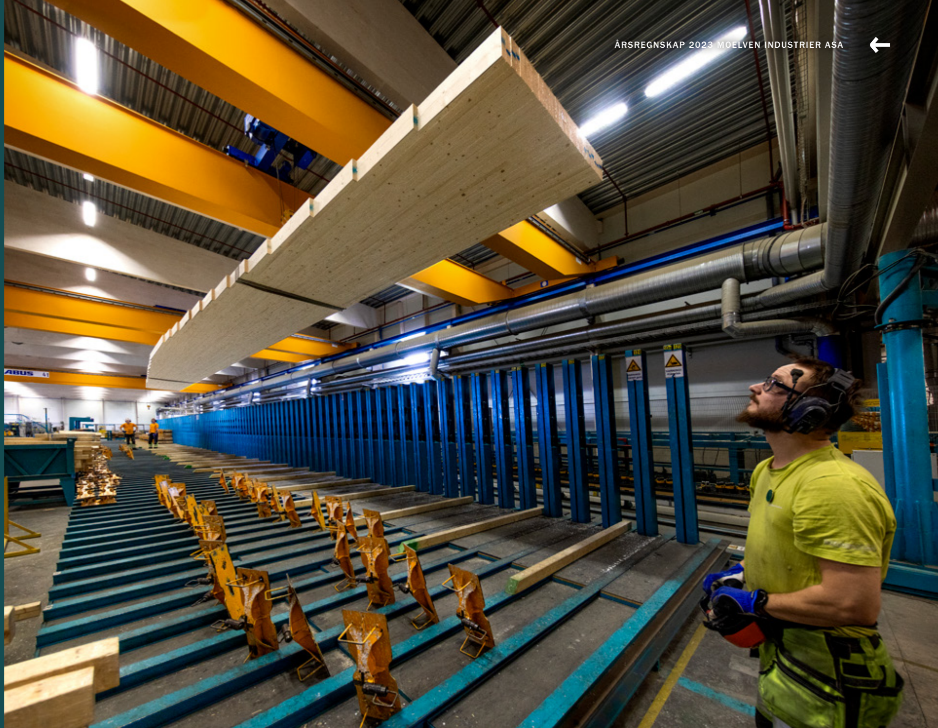
Elgigantens nye lager- og logistikkanlegg i Jönköping blir et av Nordens største. Moelvns leveranse består av over 500 saltaksbjelker, og de er 24 meter lange og nesten to meter høye. Den bærende konstruksjonen i det 86 000 kvadratmeter store bygget består i sin helhet av limtre fra Moelven Töreboda AB og Moelven Limtre AS. Foto: Sören Håkanlind og Jonas Ingman
