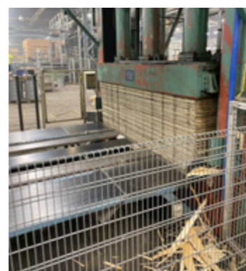
Den 24. februar 2023 ble det nyutviklede lignin-baserte limet til plywood-produksjon testet på Moelven Vänerply AB. Både håndtering, påføring og pressing i varmpressen gikk bra. Med denne typen innovasjonsprosjekter ligger Moelven langt framme i utviklingen innen plywood-produksjon. Det nye limet er fossilfritt, og har derfor potensiale til å redusere CO 2 – avtrykket betydelig og dermed bidra til å gjøre plywood til et enda mer bærekraftig og miljøvennlig produkt. Foto: Stora Enso.
